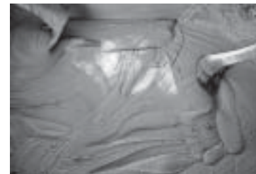
ข) เหนียวลื่น ฉาบง่าย : เนื้อปูนฉาบเหนียวลื่น ยึดเกาะดี ไม่ร่วงหล่น จึงช่วยให้ฉาบง่าย ทั้งนี้เพราะมี Micro Air Bubble หรือฟองอากาศขนาดเล็กกระจายอยู่ทั่วส่วนผสม
